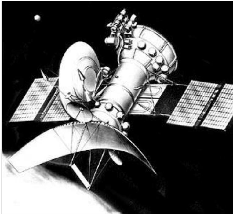
En vez de cápsulas de aterrizaje, transportaban grandes radares Polyus de apertura sintética para poder estudiar su superficie a través de las nubes, así como espectrómetros infrarrojos, detectores de rayos cósmicos y sensores de plasma solar.
